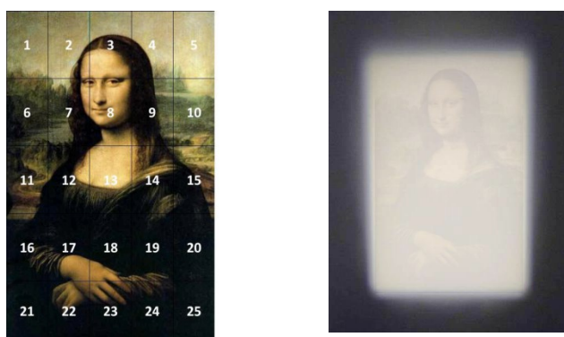
Figure 7. La distribuzione luminosa mostra un indice di uniformità pari a 0.85 con il contributo della sola lampada. Sale a 0,92 considerando anche la luce ambiente.
